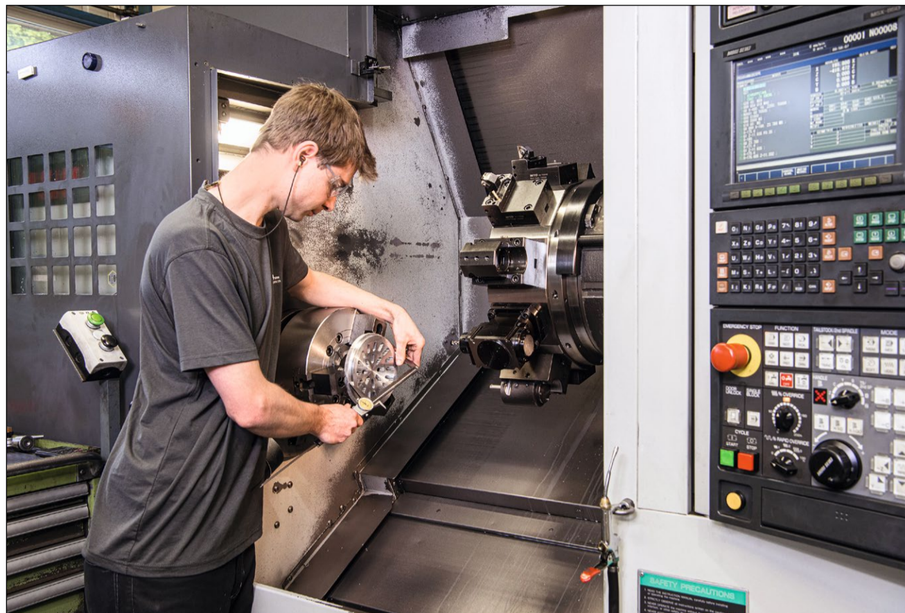
Mike Zahler misst ein Werkstück, das mit dem Dreh-Fräsbearbeitungszentrum hergestellt wird.
