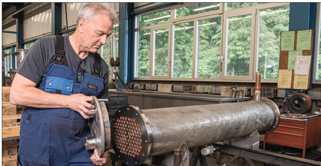
Ueli Meier montiert in der Produktionshalle einen Rohrbündel-Wärmetauscher.
