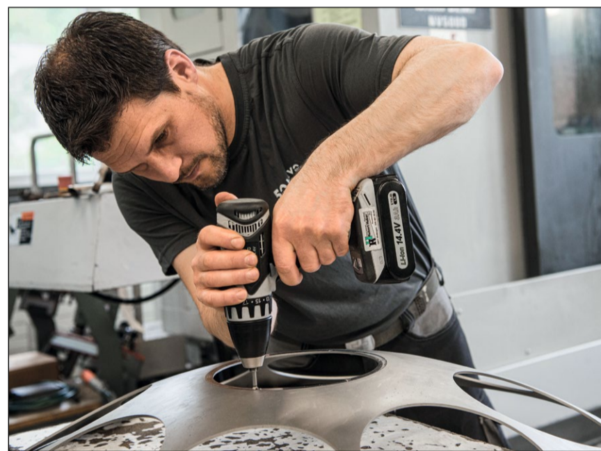
David Herzog entgratet eine Kalotte (Hightechprodukt für Halbleiterindustrie).
